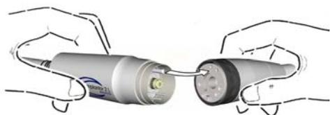
Fig. 4 – Raccordement cordon d'alim..
