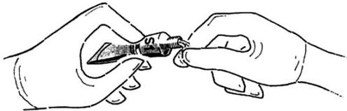
Fig. 16A - Lubrification des garnitures et tenues
