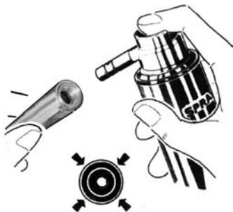
Fig. 8 – Lubrification piece à main
