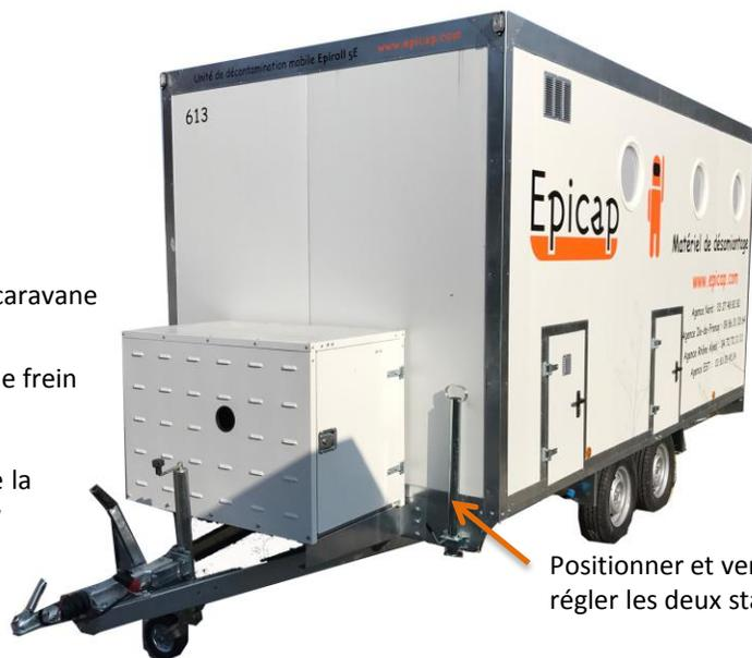
Positionner et verrouiller les 2 béquilles avant et régler les deux stabilisateurs arrières
