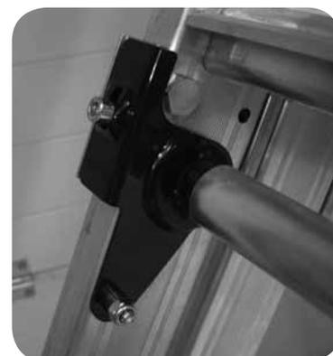
**6** « Position verrouillée ». Les têtes de vis sont en contact avec les commandes bleues.
