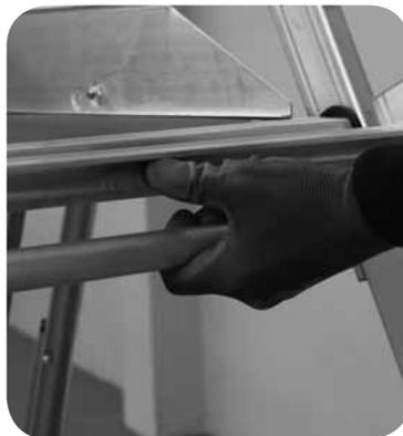
**2** Le poids de l'appareil étant retenu. Basculer la sécurité à l'aide du pouce et tirer sur la commande.
