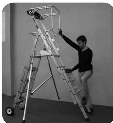
**5** Même technique coté roues, le pied en appui sur le barreau.
